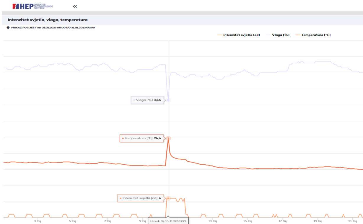
Slika 2.4 Prikaz intenziteta svjetlosti, vlage i temperature u pogonskoj zgradi TS 35/10(20) kV Brod IV tijekom planiranih radova
