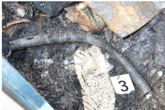
Slika 8. Metalna fleksibilna cijev sa tragovima progaranja
