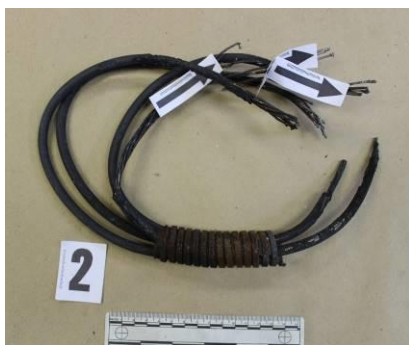
Slika 12. Termička oštećenja na priključnom kable Slika 13. Mehanička oštećenja na priključnom kable
