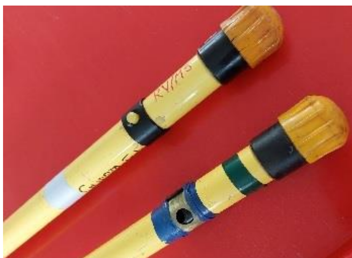
Slika 4. Konstrukcijski oštećena izolacijska motka
