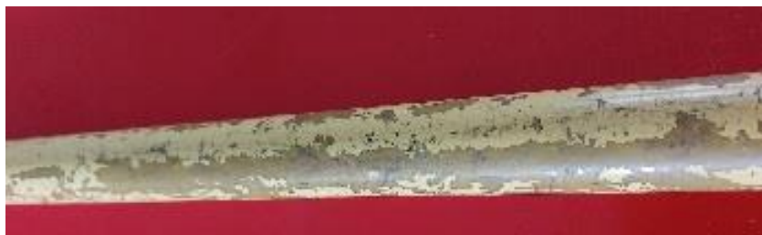
Slika 5. Mehanički oštećena izolacijska motka
