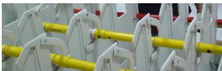
Slika 8. Priprema izolacijske motke za ispitivanje
