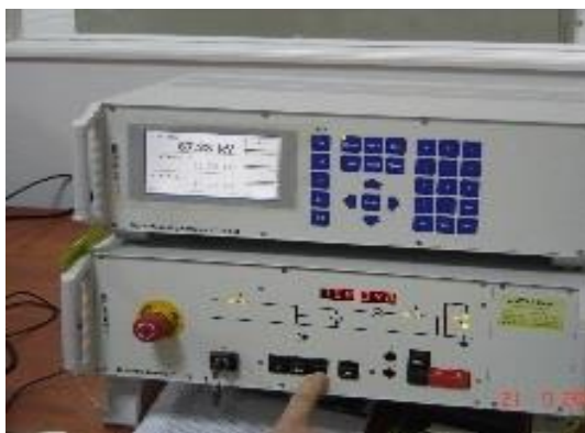
Slika 10. Podešavanje ispitnog napona i pripadna mjerna oprema
