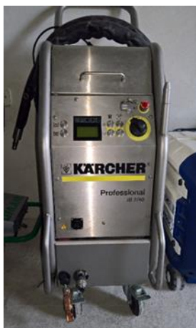
Slika 4. Uređaj za čišćenje suhim ledom dozira granule CO 2 ovisno o vrsti podloge i razini onečišćenja opreme koja se čisti.
