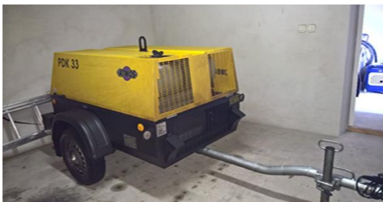
Slika 3. Kompresor - koristi se za osiguravanje dovoljne količine zraka i brzine strujanja zraka za apliciranje smrznutih granula CO 2 na onečišćenu površinu
