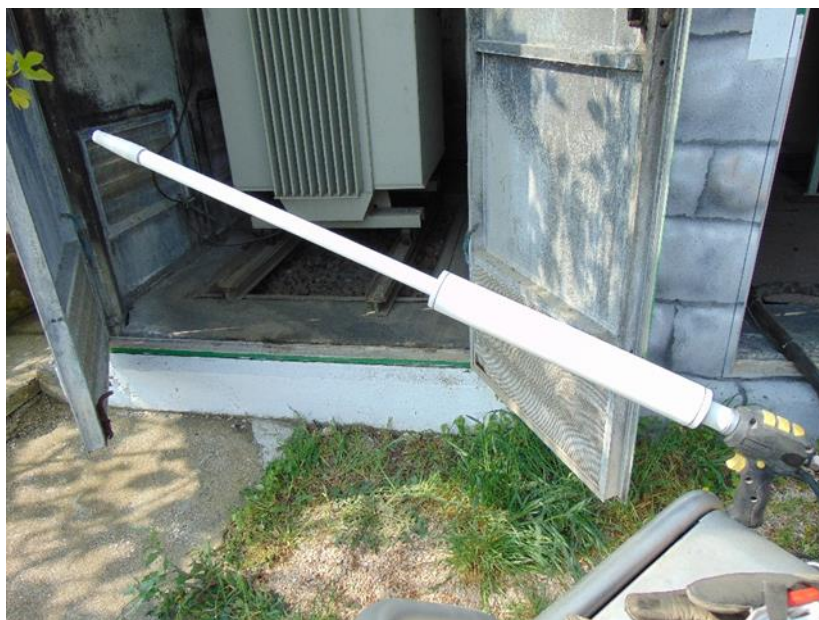
Slika 5. Patentirana mlaznica s izolacijskom ručkom za čišćenje suhim ledom pod naponom
