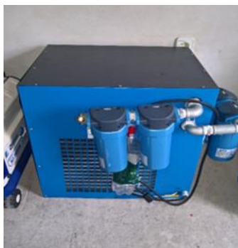
Slika 2. Sušač zraka - kompresor uzima zrak iz okoline koji u sebi sadrži određeni postotak vlage
