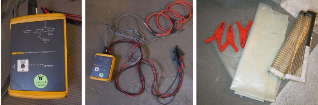
Slika 4. Mjerna garnitura sa zaštitnom opremom (izolacija) (foto: Štern)
