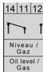
Slika 11. Preklopni kontakt razine ulja.
