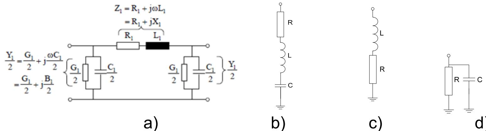
Nadomjesne sheme: a)  $\pi$ -shema voda distribucijskog NN voda, b) kondenzatorskih baterija, c) induktivnog opterećenja, d) kapacitivnog opterećenje
