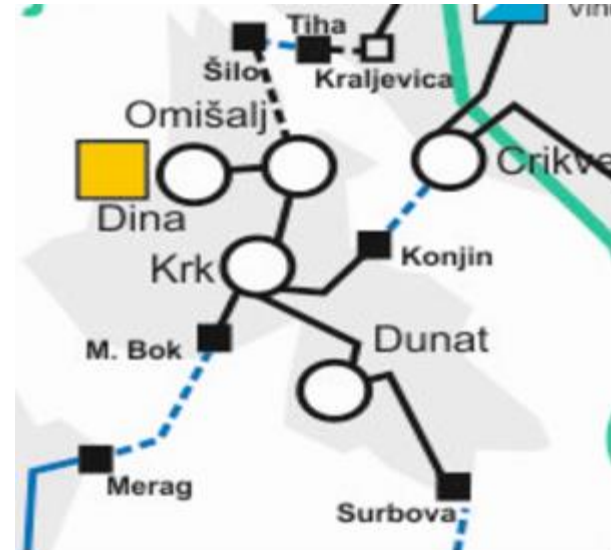
Elektroenergetski sustav otoka Krka-mreža 110 kV
