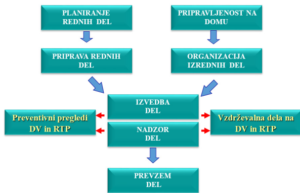
Slika 4. Proces vzdrževana VN naprav, podprt z IS Maximo
