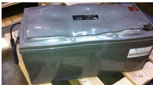
Slika 4. Plinom deformirana VRLA baterija [5]
