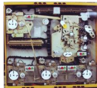
Slika 3. VDA 24 - 4VT – pogonski mehanizam opremljen elementima za daljinsko upravljanje
