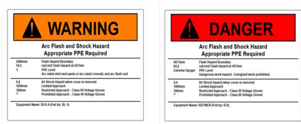
Slika 5. Oznaka o graničnoj udaljenosti, energiji električnog luka i razini zaštitne opreme prema NFPA 70E za 0.4 kV sabirnicu BUS 4 i sabirnicu RAFINERA
