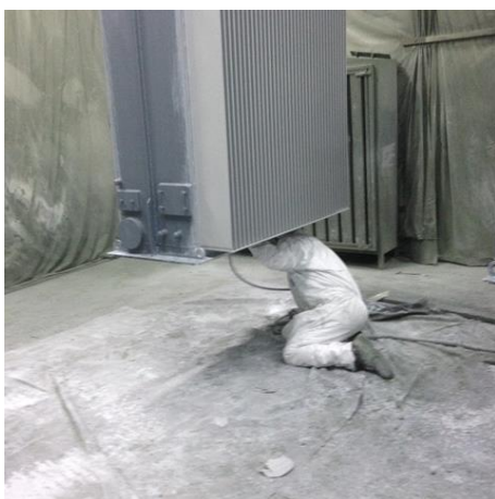
Slika 3. Prskanje, kao metoda nanosa boje. Ljevo- nanos boje u unutrašnjosti kotla, Desno ravne površine poklopaca pogodne su za nanos boje prskanjem.
