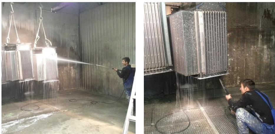
Slika 1. Odmaščivanje valovitog kotla, vanjske i unutarnje površine
