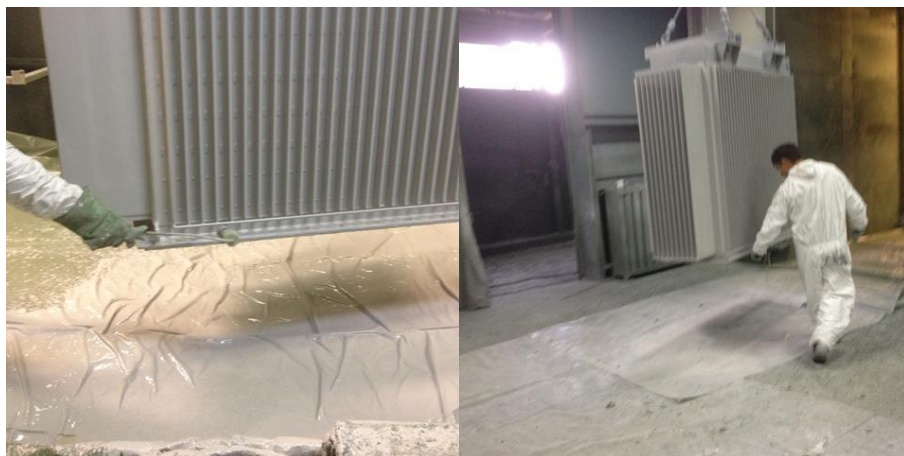
Slika 5. Prikupljanje viška boje valjcima. Lijevo iznad kade, desno u tunelu za prikupljanje boje
