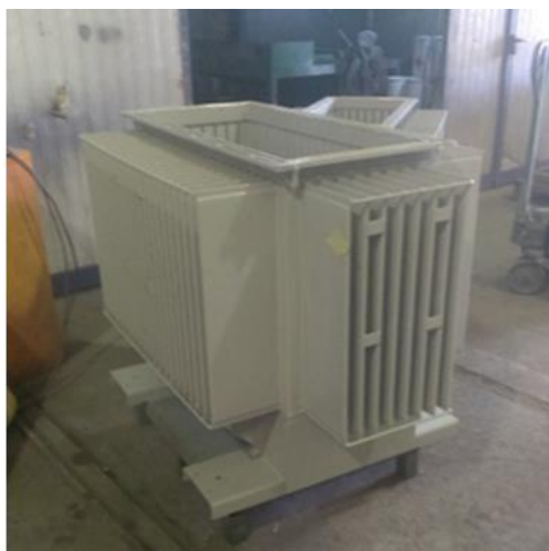
Slika 4. i 5. Kotao i poklopac zaštićeni prahom
