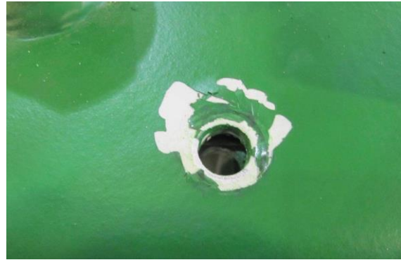
Slika 6. i 7. Oštećenja boje na poklopcu nastalo pritezanjem vijaka
