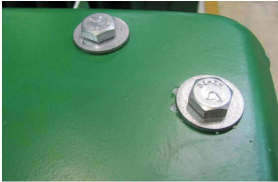
Slika 6. i 7. Oštećenja boje na poklopcu nastalo pritezanjem vijaka
